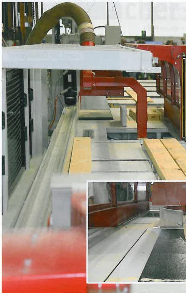
▲ Die Kappanlage SlimLine (hier in Basisversion), erweitert um eine Besäumsäge. Links das Schiebeseystem mit Puffereinrichtung, mittig die Kapstation und rechts drei Abschiebetische
