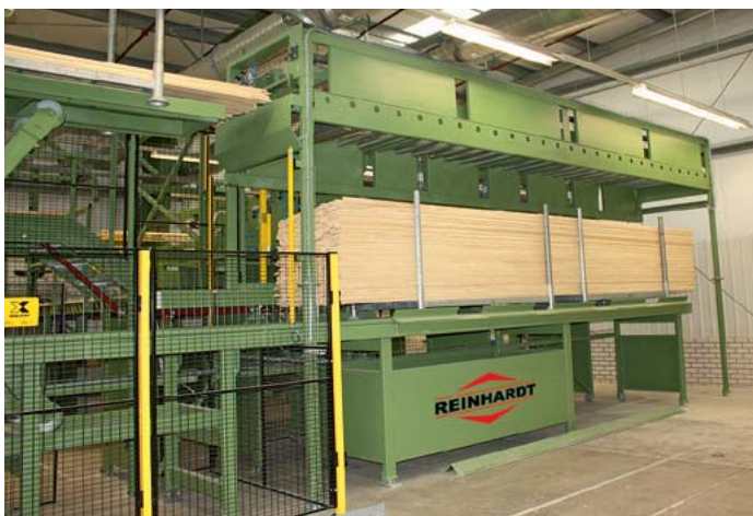
Aufgabestation der keilgezinkten und gehobelten Lamellen , nach links geht es weiter zum Hubtisch und damit in die obere Etage
