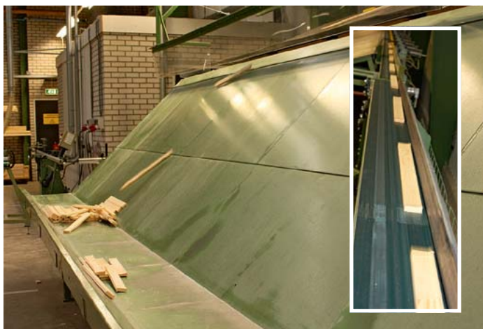
Ab geht die Post: am Auslaufband (kl. Bild) befinden sich 21 Abwurfstationen für verschiedene Qualitäten und Längen
