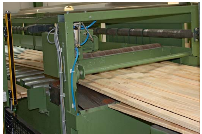
Vereinzlung der Pakete – zuerst annähernd lageweise und dann mit einer speziellen Kaskadeneinrichtung Stück für Stück
