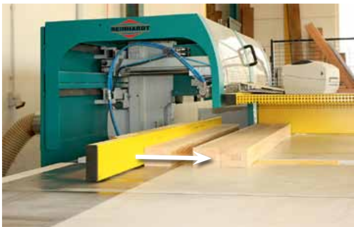
Abschieben nach dem Schnitt: Die gekappten Fensterkante lassen sich so bequem abnehmen und stapeln
