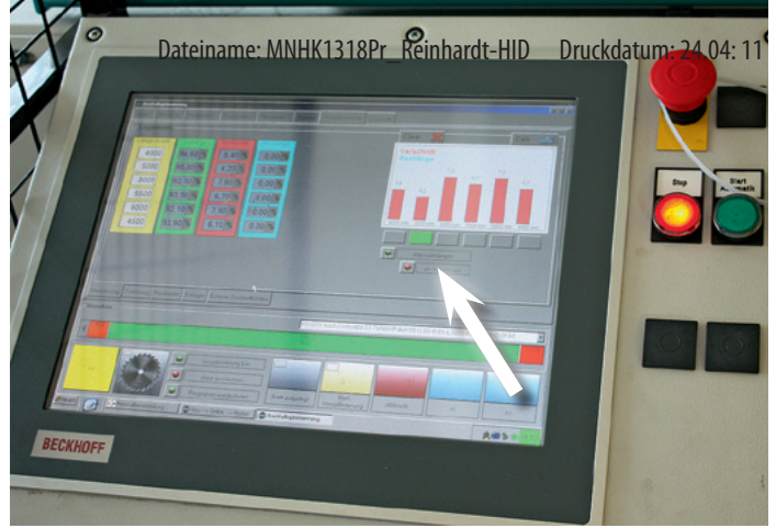
Das Touchpanel ist übersichtlich gestaltet , oben rechts (s. Pfeil) wird etwa angezeigt, wie viel Verschnitt bei welcher Eingangslänge erzeugt wird
