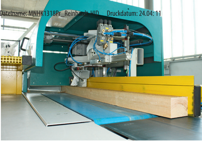
Das Werkstück wird beim Kappschnitt oben und seitlich geklemmt, danach geht's aufs Sortierband
