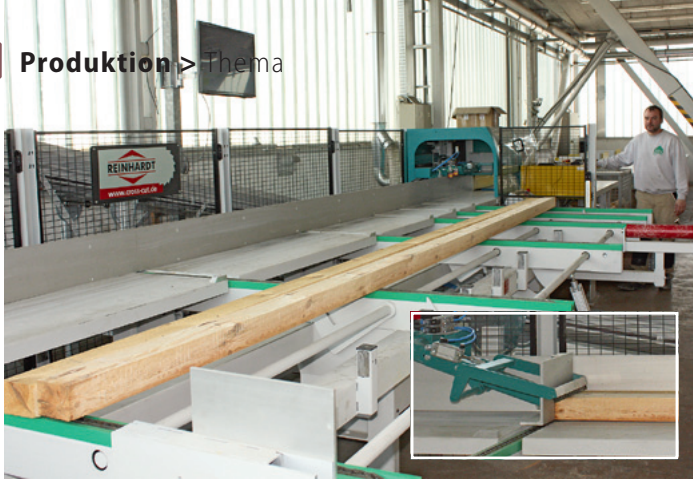
Einzug mit Querkettenbeschickung und Puffer , danach übernimmt der Schieber mit Klemmung die Schnittware (kl. Bild)
