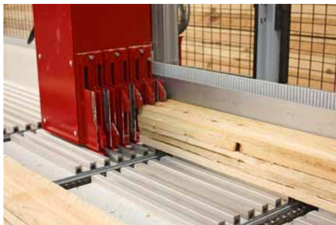
Perfekter Halt: Der Schieber bei der QuickStop von Reinhardt ist mit einer Klemmvorrichtung ausgestattet
