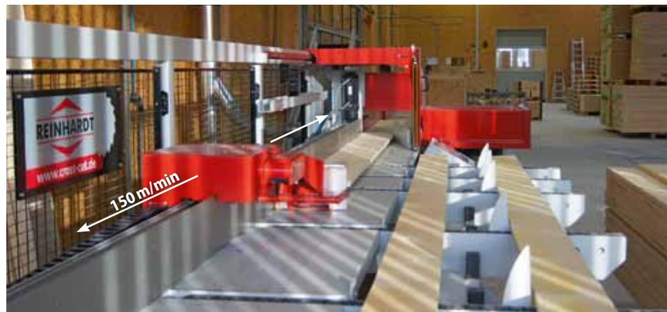
Hochleistung im Klosterbetrieb: In der Tischlerei des Klosters Mehrerau wird die Reinhardt-Slime-Line für den Zuschnitt von Verpackungsholz genutzt – da zahlen sich 150 m/min Vorschub aus
