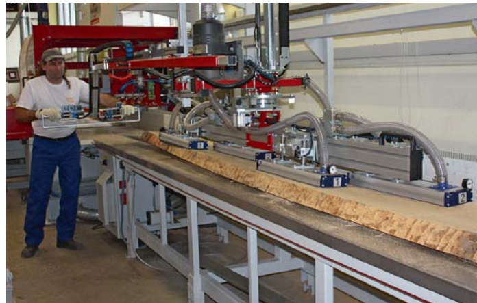
Ergonomisch: Der Mitarbeiter platziert die unbesäumten Hölzer einfach und ohne große Anstrengung am Einzugstisch der Kappsäge
