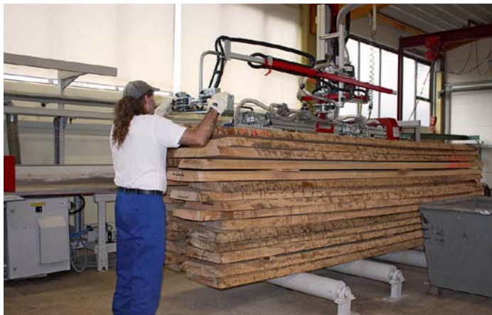
Die unbesäumte Brettware wird mittels des Vakuumhebe geräts von IHF-Jungenthal ab gestapelt
