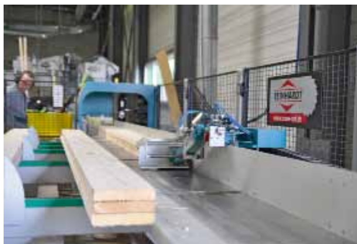
Großzügige Beschickung: Die Slim Line ist bei der Aufgabe mit einem großen Puffer ausgestattet, sodass ein Mitarbeiter die ganze Anlage bedienen kann
