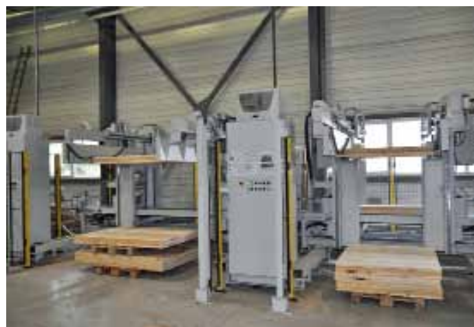
Ausgeklügeltes System: Während die eine Stapelmaschine bereits Bretter verarbeitet, steuert das Band die zweite an – so ist ein hoher Ausstoß möglich
