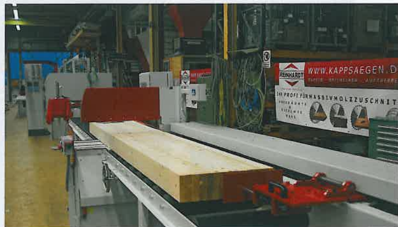
Bewährt und begehrt: Die Basicline eignet sich zum Ablängen von Leimholz, wie auf der Hausmesse demonstriert wurde
