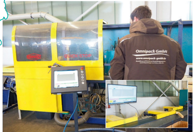
Die Quick-Stop verfügt nun über eine neue Steuerung sowie ebenso einen großen Bildschirm an der Auslaufseite (kl. Bild)
