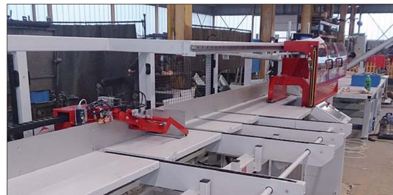
Eine um eine Besäumeinheit aufgerüstete »Slim-Line«-Anlage. Die Besäumeinheit (rote Abdeckung) ist im Einlauf zur Kappsäge installiert. Etwas links von der Bildmitte ist der Positionierschieber zu sehen. Fotos: Reinhardt
