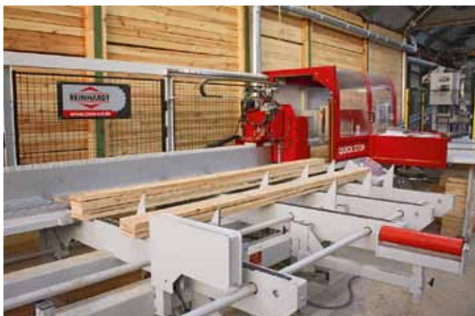
Zuführung in QuickStop bei Schneider: Aufgrund der Pufferplätze bei der Aufgabe reicht meist ein Mitarbeiter für die Bedienung
