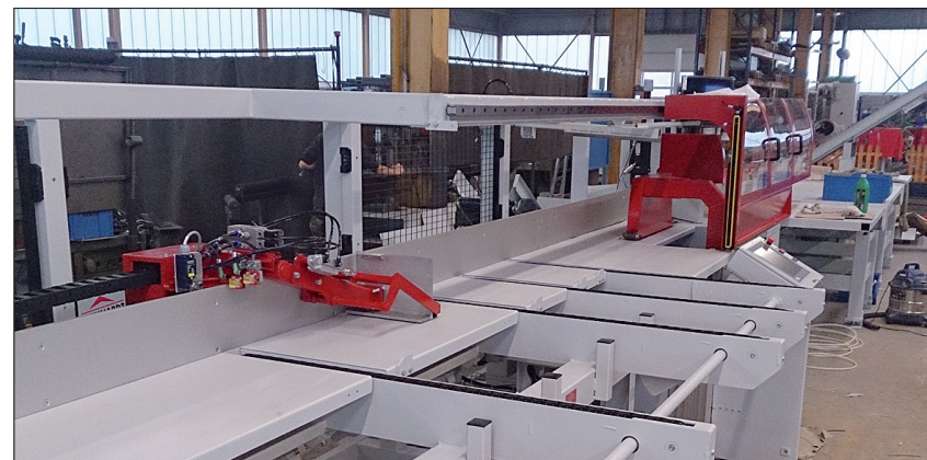
Eine um eine Besäumereinheit aufgerüstete »Slim-Line«-Anlage. Die Besäumereinheit (rote Abdeckung) ist im Einlauf zur Kappsäge installiert. Etwas links von der Bildmitte ist der Positionierschieber zu sehen. Fotos: Reinhardt
