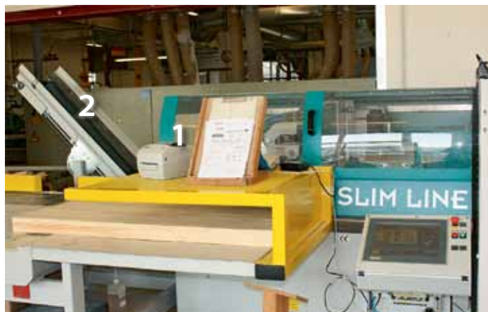
Die Slim-Line bei Timm ist mit einem Barcode-Etikettendrucker (1) und einer automatischen Abfallsorgung (2) ausgestattet
