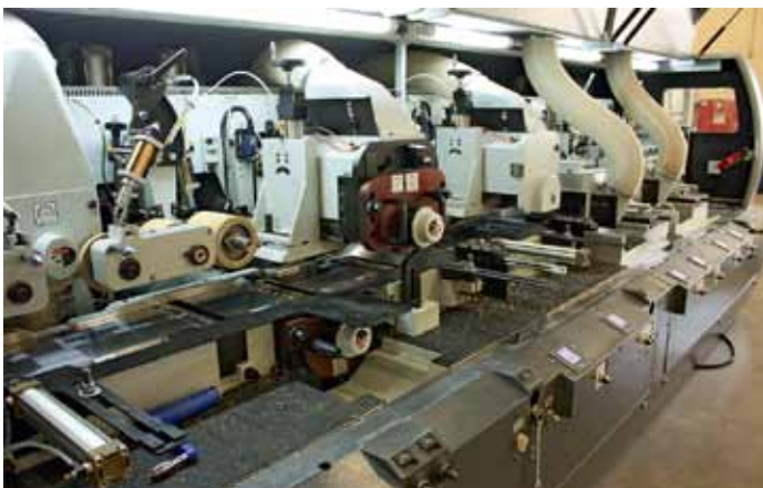
Acht Spindeln und ein Sägeaggregat sorgen für eine Rundumbearbeitung der Fensterkanteln
