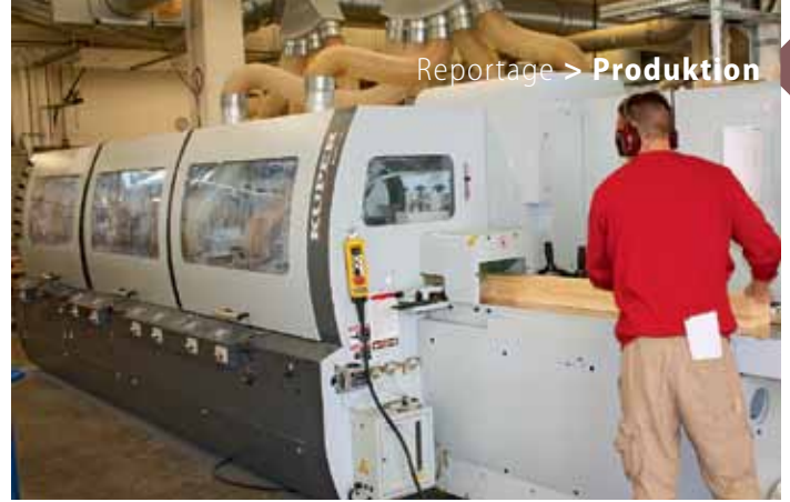
Die Aufgabe der Fensterkanteln erfolgt händisch , die Dimensionen gibt der Bediener manuell ein oder die Maschine liest den Barcode
